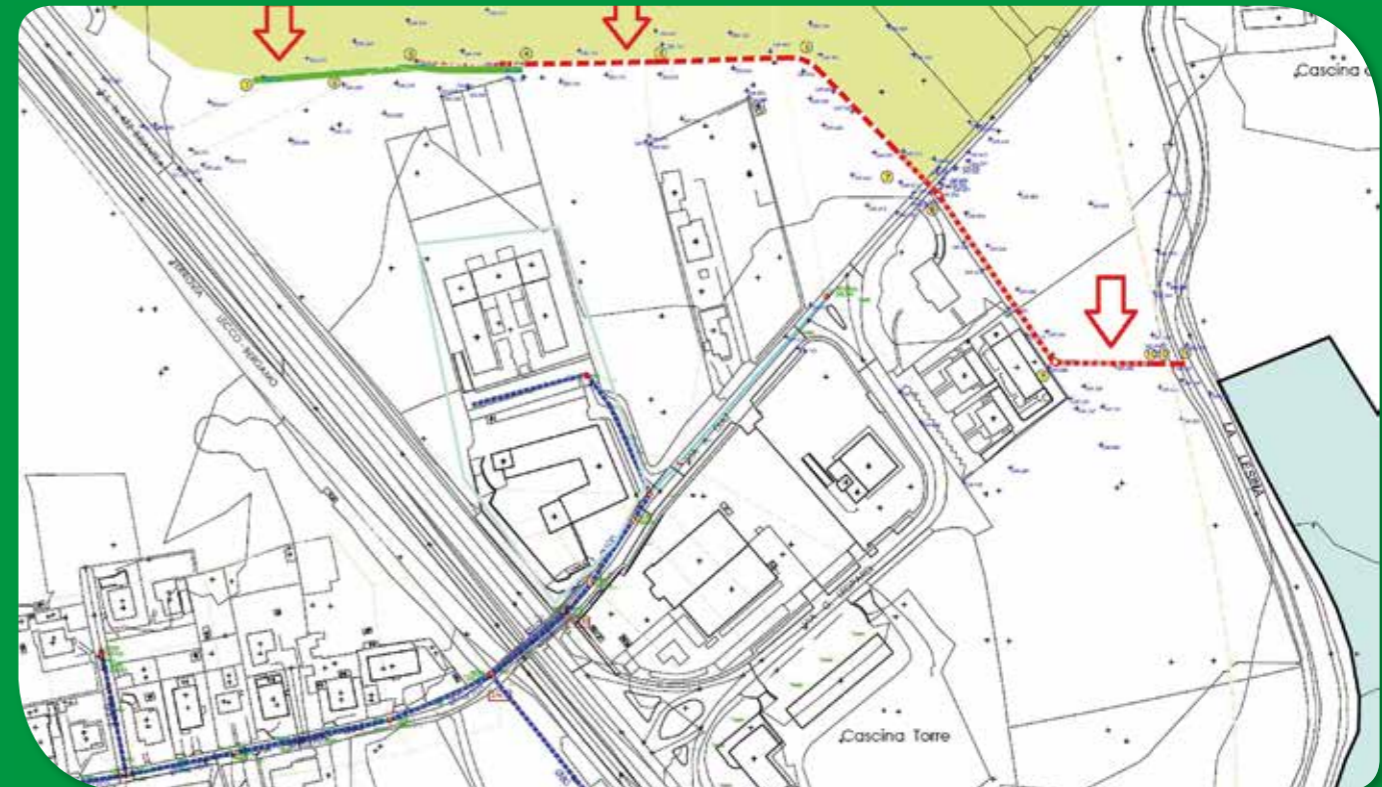
NUOVO COLLETTORE NELL'AREA NORD DI LOCATE, COLLEGATO ALLE VASCHE DI LAMINAZIONE, PER LA RACCOLTA DELLE ACQUE PIOVANE: PROGETTO APPROVATO, GARA D'APPALTO CONCLUSA NEL 2020, INIZIO LAVORI GENNAIO 2021
